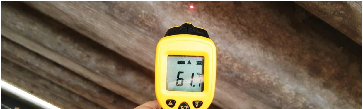
Figura – V Medição de temperatura de superfície interna das telas “fibrocimento” com termômetro infravermelho.
