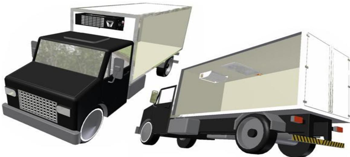
Figura 5 – Detalhe dos dois sistemas, as 2 placas eutéticas, mais o sistema de ar forçado
