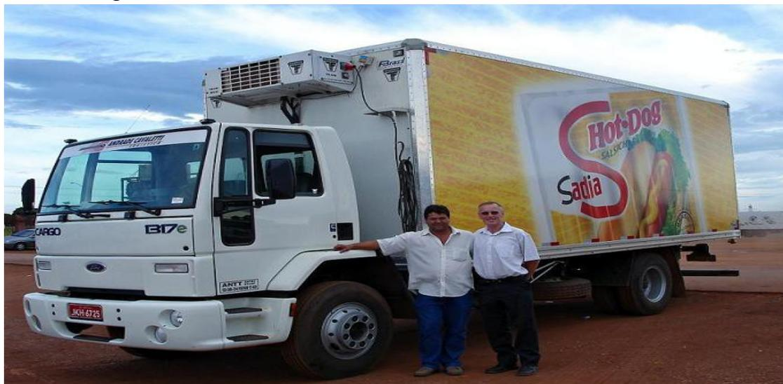
Figura 3 - Baú frigorífico TOCO PALLETEIRO com 6,5 m de comprimento
