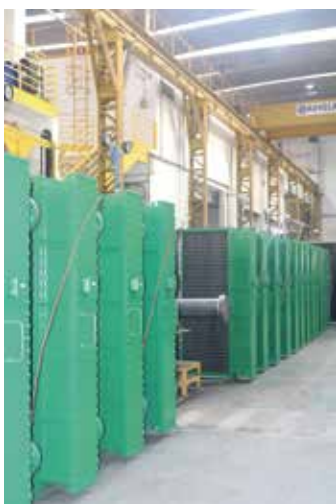
Resfriadores de geradores
